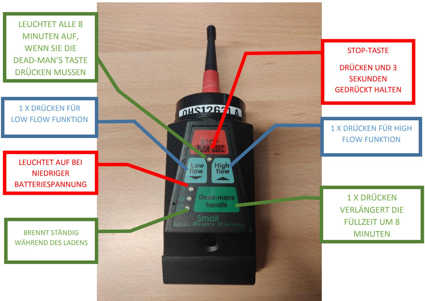
Drücken Sie jede 8 Minuten einmal leicht die **grüne Dead-man's handle** Taste. Jede 8 Minuten fängt an der Anlegestelle ein Licht für 2 Minuten an zu blinken.
